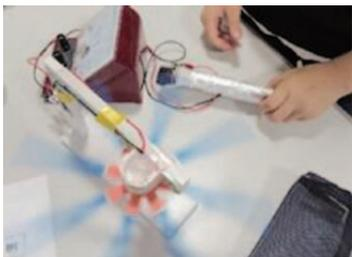
備長炭電池の実験。アルミホイールを巻いて電気を作り、メリーゴーラウンドを回したよ！
